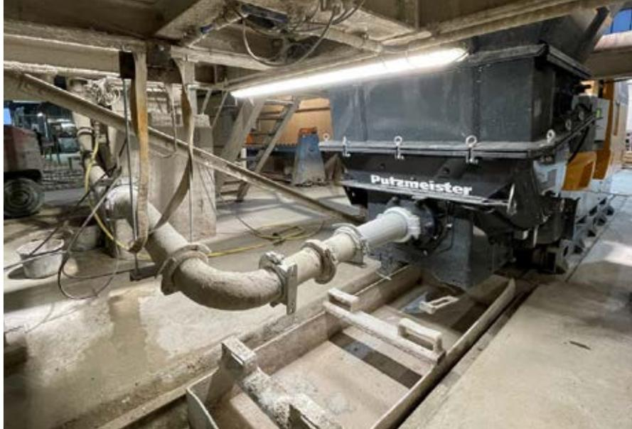
Putzmeister Aufsatztrichter 3.200 l mit Schnellverschluss zur Entkoppelung von der Betonpumpe. Mit neu hinzugefügter Recyclingwanne unterhalb der Pumpe für eine schnellere Reinigung von Pumpe und Trichter.
